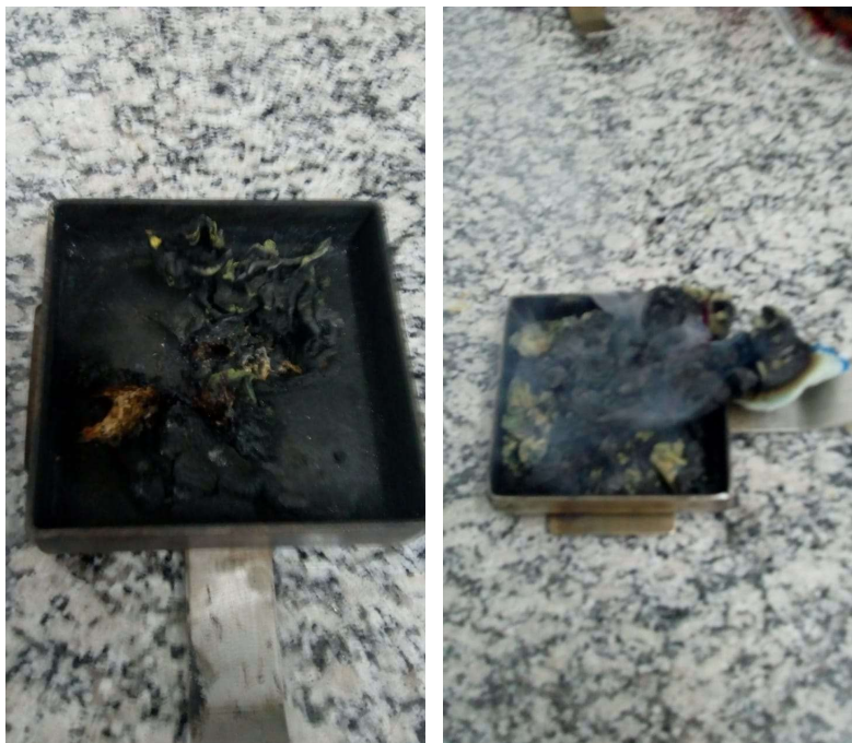
Figuras 9 e 10 – Luvas vaqueta e raspa de couro, pós Ensaio de Radiação
