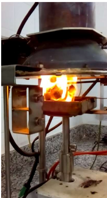
Figura 8 – Ensaio no Cone Calorímetro
