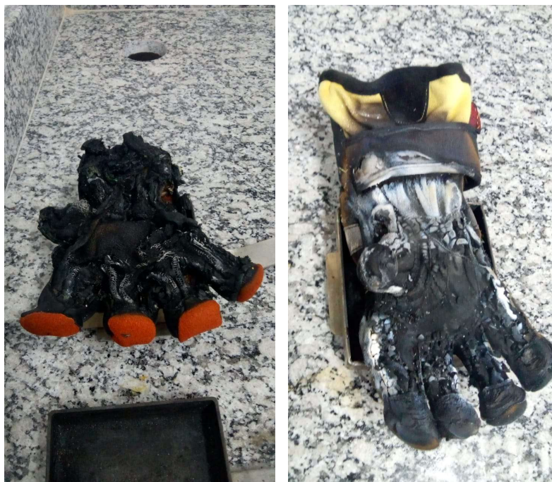
Figura 11 e 12 – Luvas T-Rex e Jobefire, pós Ensaio de Radiação
